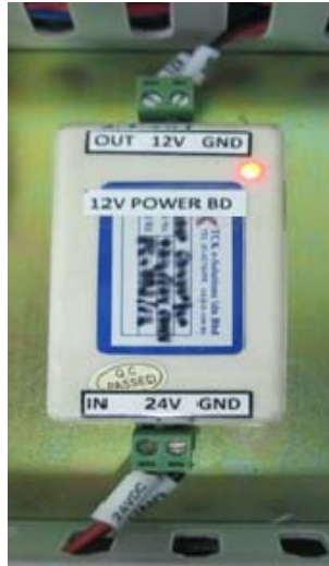
Gambar 7 : 12 Volt Power Board
